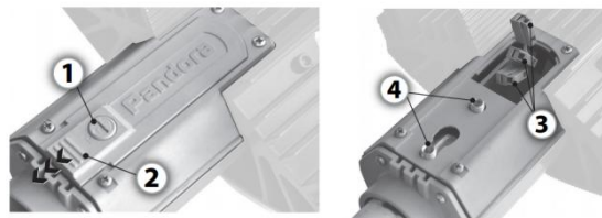
Рисунок 2. Схема установки светильника на кронштейн.
